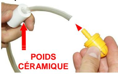
Couper le tube à la longueur nécessaire. Raccorder le filtre/ le clapet de pied jaune au tuyau comme illustré. Glisser le poids céramique sur le tube et autant que possible sur le raccord canelé sur le clapet de pied jaune.
