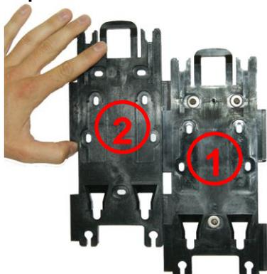
Pour installer un dispositif multiple, commencer par installer le premier étrier au mur comme illustré à l'étape 1. Puis glisser du haut vers le bas le second étrier dans la fente située sur le côté gauche de l'étrier 1, jusqu'à ce qu'ils soient parfaitement alignés et fixés.
