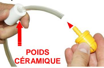
Couper le tube à la longueur nécessaire. Raccorder le filtre/ le clapet de pied jaune au tuyau comme illustré. Glisser le poids céramique sur le tube et autant que possible sur le raccord canelé sur le clapet de pied jaune.
