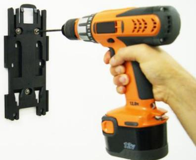
Utiliser l'étrier comme s'il s'agissait d'un gabarit pour marquer les trous de montage. Percer les trous pour les ancrages ¼" fournis et fixer l'étrier à l'aide des vis fournies.
