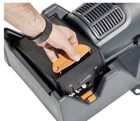
L'accès aisé à la batterie rend le chargement simple et rapide
