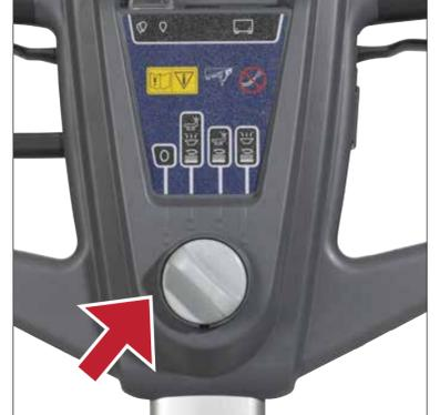
4 Vérifiez si le bouton de sélection n'est pas mal positionné
