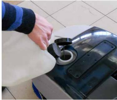
2. Remplissez le réservoir avec une solution adaptée au nettoyage à effectuer
