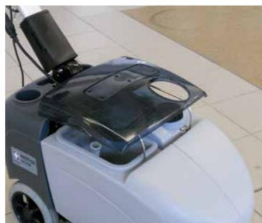
18. Positionnez la machine avec le couvercle du réservoir de récupération ouvert
