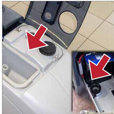
2 Ouvrez le bac de récupération et contrôlez si la grille d'aspiration et le joint sont propres
